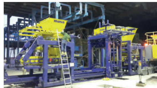
Montage de l'installation de production de blocs en béton Masa XL 9.2
