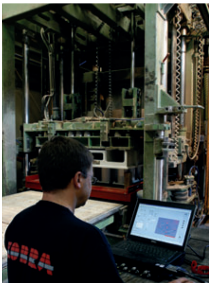
Évaluation et analyse des cycles du processus de compactage à l'aide de la mesure de vibrations sur maximum 8 canaux en même temps.
