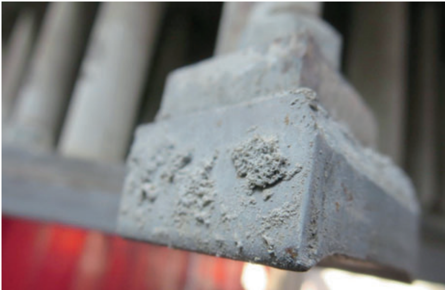
Traces d'usure typiques : usure unilatérale des chanfreins
