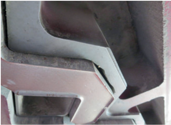
« Traces en forme de pattes d'éléphant » sur le bas de caisse du moule
