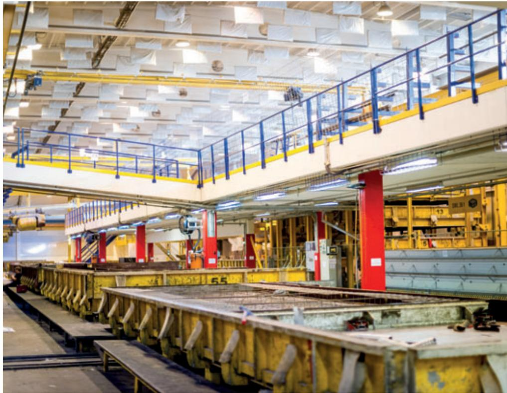
*Le volume de production de l'usine reste constant, depuis 2002, à 750 tonnes / jour grâce à la solide prestation d'ELIPLAN. Pour les seules façades, l'usine possède 25 bancs (10 m x 4 m), chaque banc étant conçu pour des épaisseurs de béton de 450 mm.*
