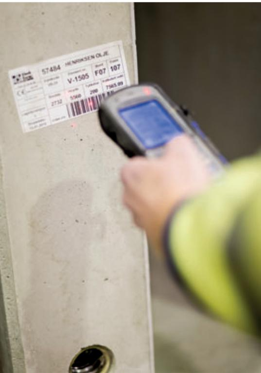
Grâce au système de code-barres d'ELiPLAN, le suivi des éléments préfabriqués en béton se fait de façon simple et sans problème.
