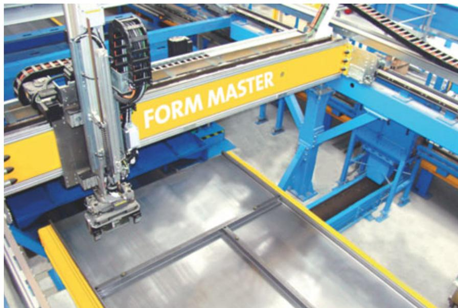
Le nouveau système de coffrage Infinity Line développé et breveté par Progress Group permet de coffrer des éléments préfabriqués en béton sans trame et pratiquement sans utiliser d'éléments de remplissage.
