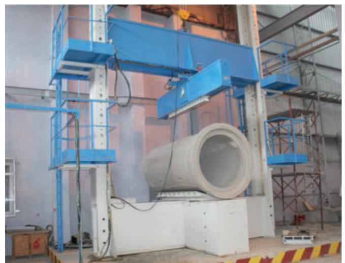
Presse de contrôle de la pression maximale
