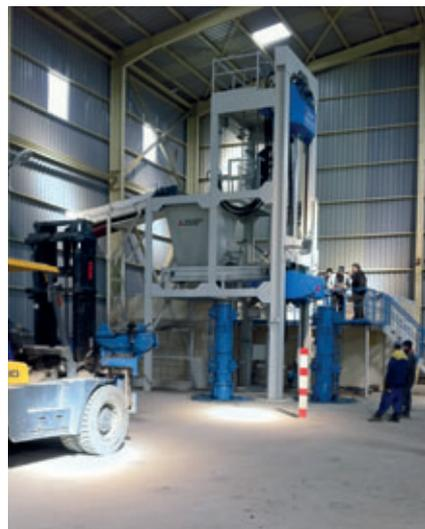
Presse radiale RP 1225 - Machine hautement performante pour les tuyaux d'évacuation d'eau, avec joint intégré DN 300 - 1200 mm, longueur utile 2,5 m chez Sarl Etber, Bouira
