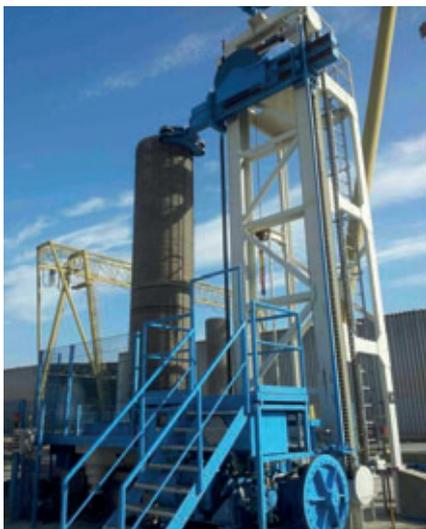
Machine de précontrainte verticale dans l'usine Hydroaménagement de Rouiba/Alger pour enrouler les tubes centraux de diamètres compris entre DN 600 et DN 2000, et d'une longueur utile de 6 m.
