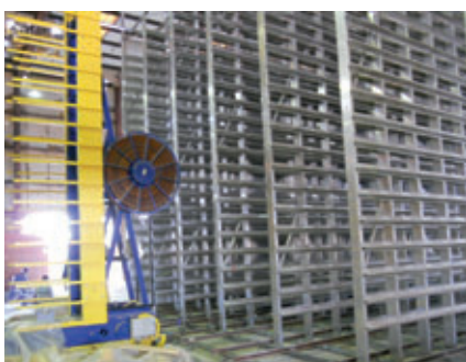
La nueva estantería de aluminio HS con el carro multiforca de Masa
