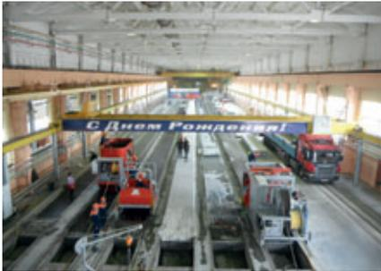
La nueva línea para la fabricación de placas alveolares pretensadas en la planta de producción del holding SU-155 en Domodedovo, fue entregada y montada exitosamente por la empresa «Echo Precast Engineering».
