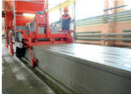
La máquina deslizante no solo fue diseñada para la producción de placas alveolares pretensadas con espesores de 60 a 600 mm, sino también para la fabricación de pilotes, dinteles y placas de hormigón para carreteras.
