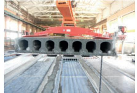
Retirada de una placa alveolar pretensada
