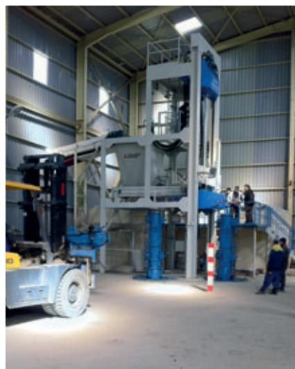
Prensa radial RP 1225, una máquina de altas prestaciones para tuberías de aguas residuales con junta integrada DN 300 – 1200 mm, longitud 2,5 m en Sarl Etber, Bouira
