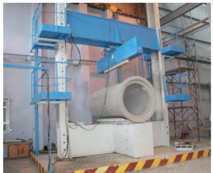
Prensa para ensayo de aplastamiento
