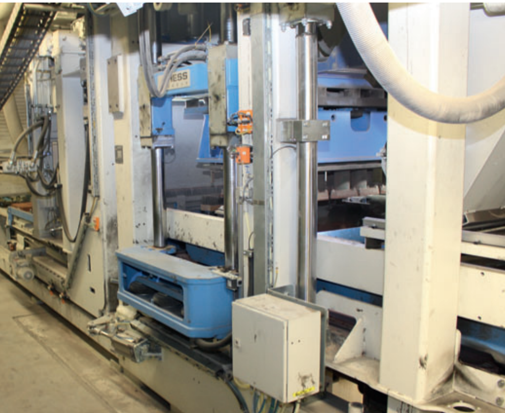
3.ª Hess RH 2000-3 MVA, tamaño de bandeja de 1450 x 750 mm, puesta en funcionamiento a comienzos de 2014
