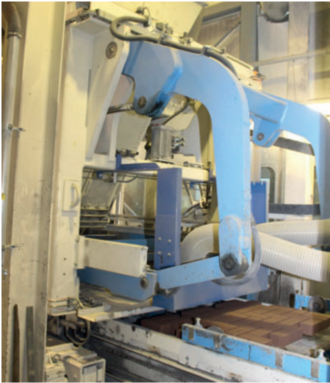
1.º Hess RH 2000-3 MVA, tamaño de bandeja de 1450 x 1250 mm, puesta en funcionamiento a mediados de 2011
