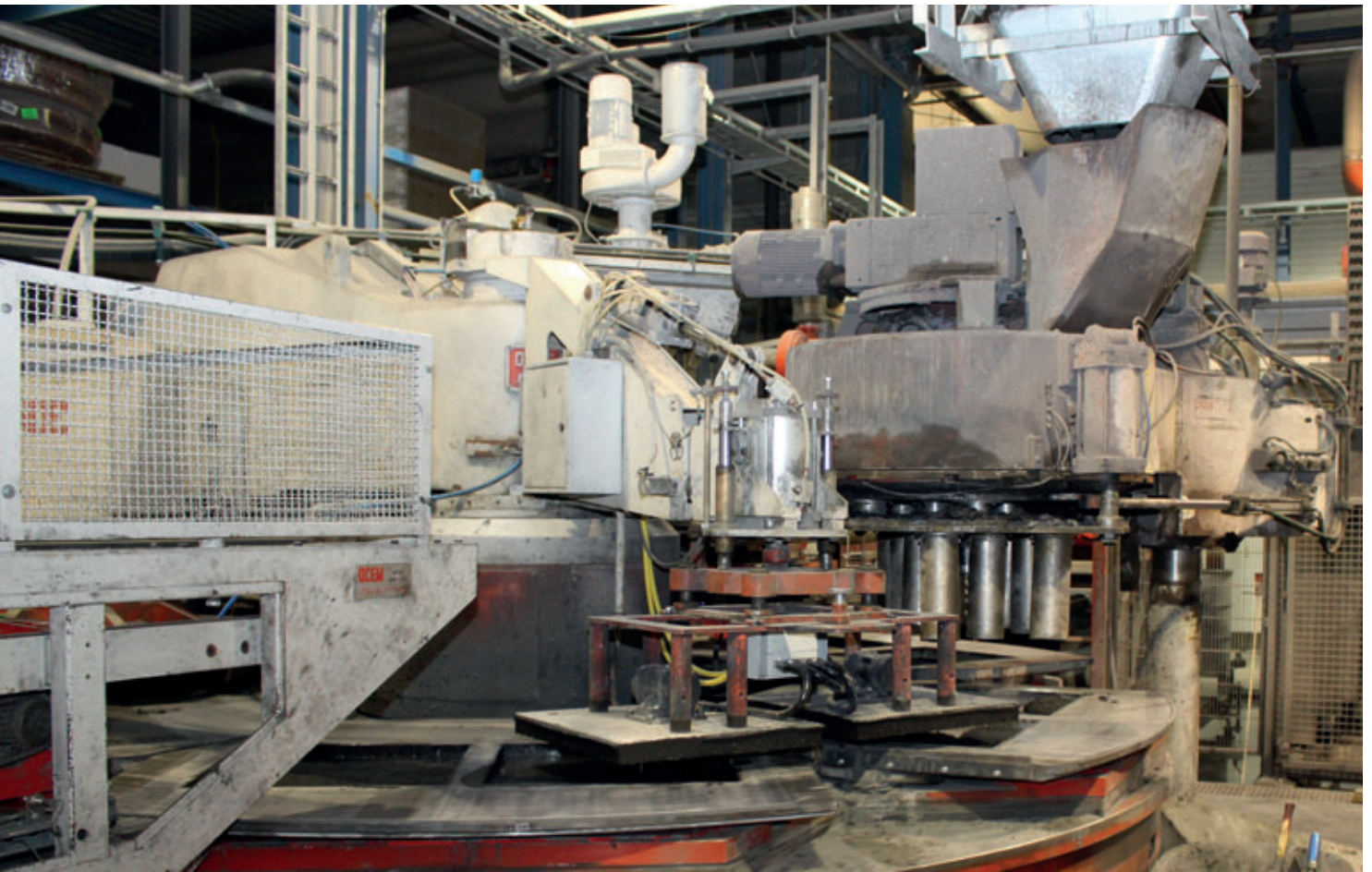
Prensa hermética de mesa giratoria con una fuerza de presión de 14 000 kN de SR-Schindler
