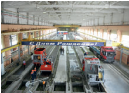
Lieferung und Montage der neuen Linie für die Fertigung von Spannbetonfertigdecken im Produktionsstandort Domodedowo der Holding SU-155 wurden von der Firma „Echo Precast Engineering“ mit Erfolg durchgeführt.
