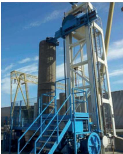
Vertikal Vorspannmaschine im Werk Hydroaménagement Rouiba/Algiers zum Wickeln von Kernrohren DN 600 bis DN 2000, BL 6 m.
