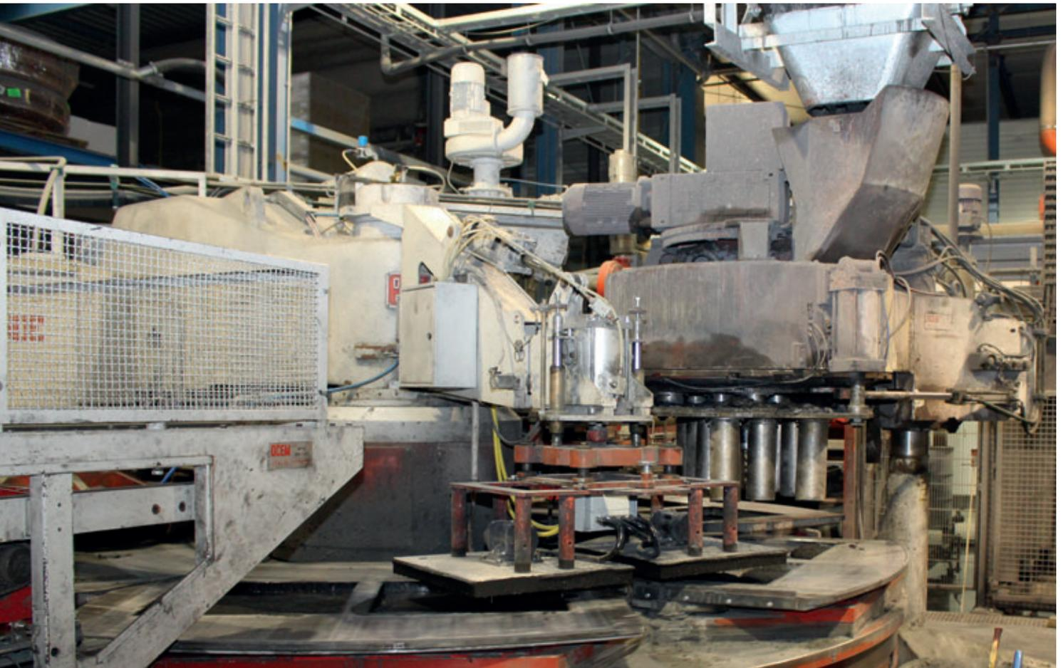
Hermetik-Drehtischpresse mit 14.000 kN Presskraft von SR-Schindler
