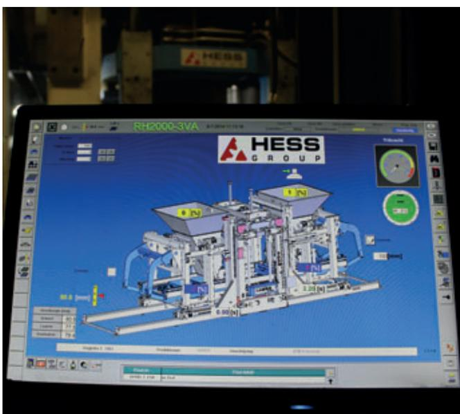
Vom Kontrollraum aus können alle Produktionsabläufe der Betonsteinfertiger RH 2000-3 MVA direkt beobachtet werden.
