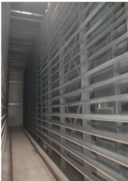
Während der Aushärtung bei einer Temperatur von 35°C (100°F) und einer relativen Luftfeuchtigkeit von 100% aufgenommene Fotografie – Trockenstrich, Schienen und Regale. Der Zuluftkanal mit Jalousien befindet sich rechts neben dem Bild.
