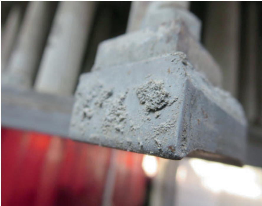
Typische Verschleißbilder: einseitiger Faserverschleiß
