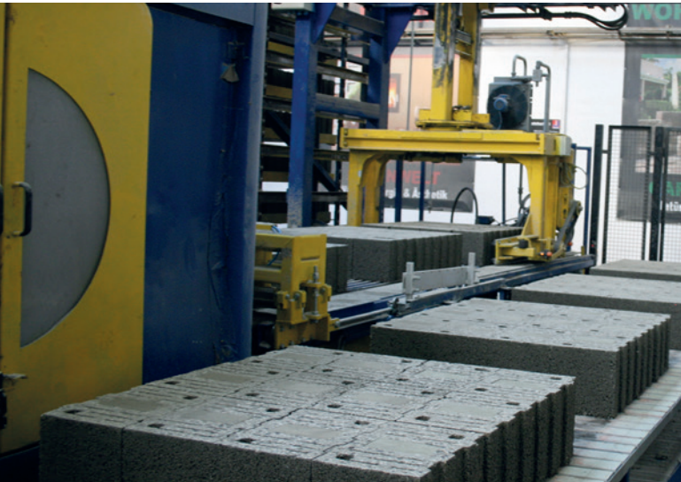
После фрезерования пластинчатый транспортер доставляет блоки на станцию пакетирования
