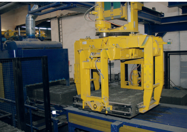
Грейфер захватывает блоки полойно со стальных поддонов и подает их на шлифовальный станок
