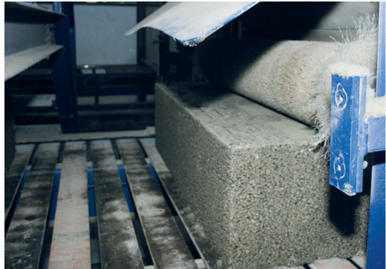
Обработка щетками для удаления фрезерных следов
