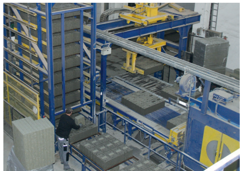
Рабочий закладывает заранее нарезанные изоляционные элементы в блоки Jasto Plan Therm
