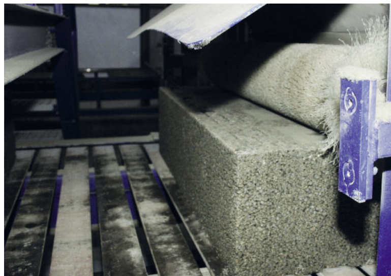
Ostatnie szczotkowanie powierzchni w celu usunięcia ewentualnych pozostałości po frezowaniu.
