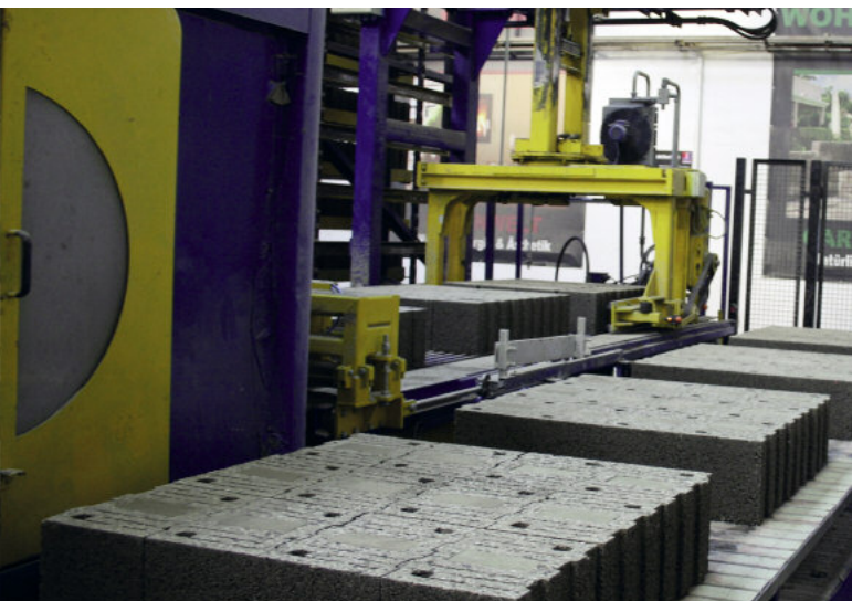
Po frezowaniu bloczki układane są na przenośniku płytowym, które transportuje je na stanowisko pakietowania.
