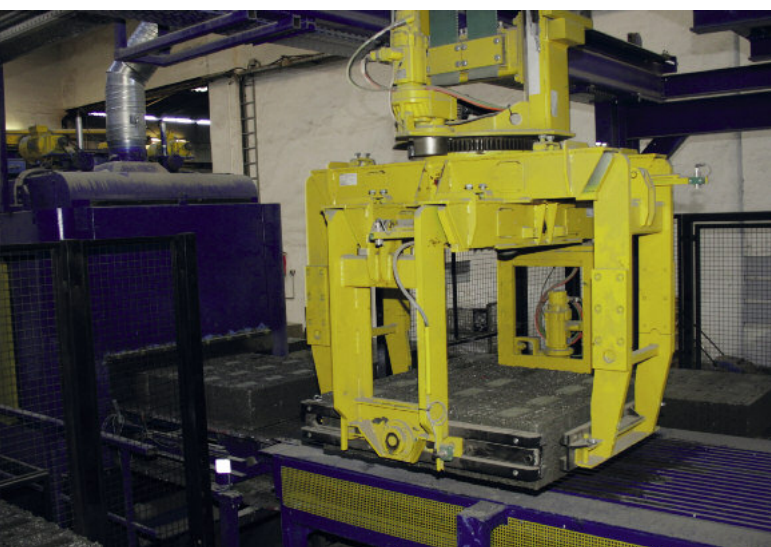
Chwytnak zdejmując bloczki ze stalowych podkładów warstwami i przemieszcza je przed maszynę do szlifowania.
