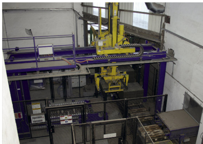
Pakietowanie bloczków z pumeksobetonu na drewnianych paletach.
