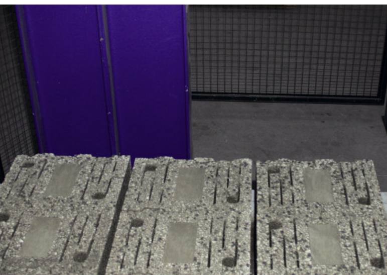
Przed pakietowaniem warstwy wyrobów są lekko rozdzielane, aby późniejsze pakiety wyrobów były lepiej napowietrzane.
