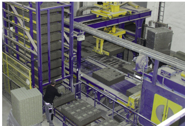
Pracownik umieszcza przycięty materiał izolacyjny w pustych gniazdach bloczków Jasto Plan Therm.
