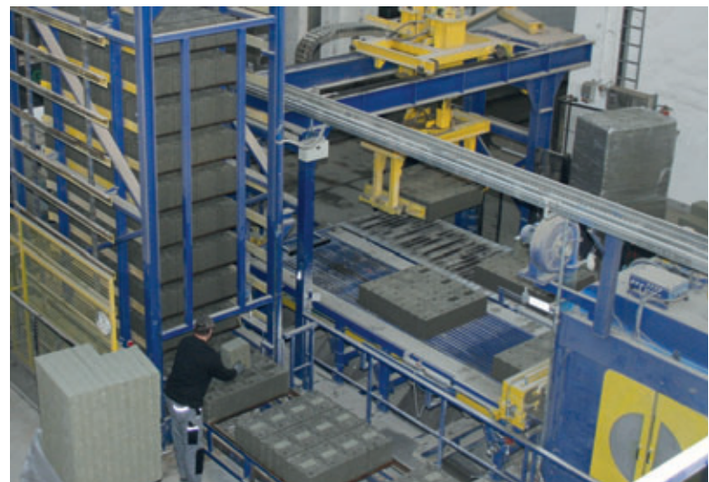
Un collaboratore inserisce l'isolante debitamente pretagliato nelle cavità dei blocchi Jasto Plan Therm.
