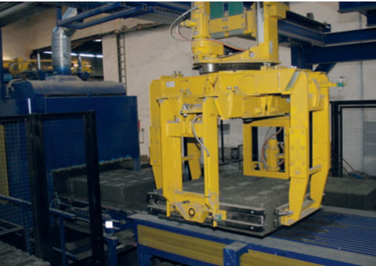
Il dispositivo di presa preleva i blocchi a strati dalle lamiere d'acciaio e li deposita davanti all'impianto di rettifica.
