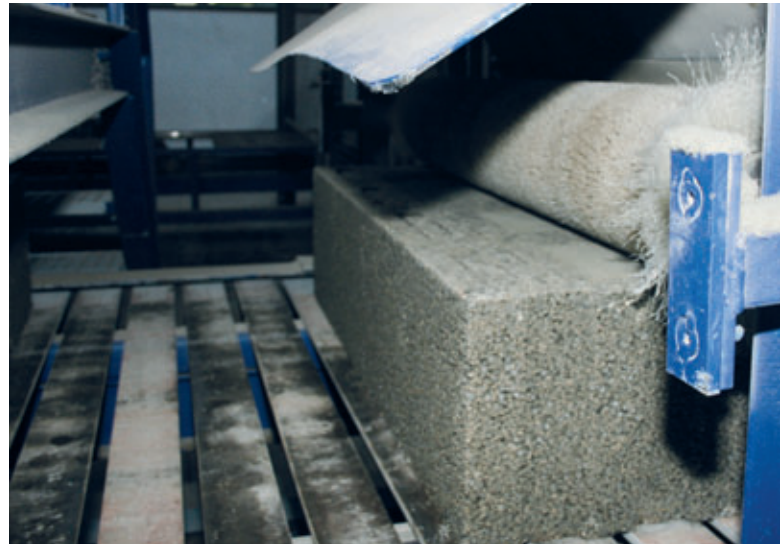
Un'ultima spazzolatura della superficie per eliminare eventuali residui di fresatura
