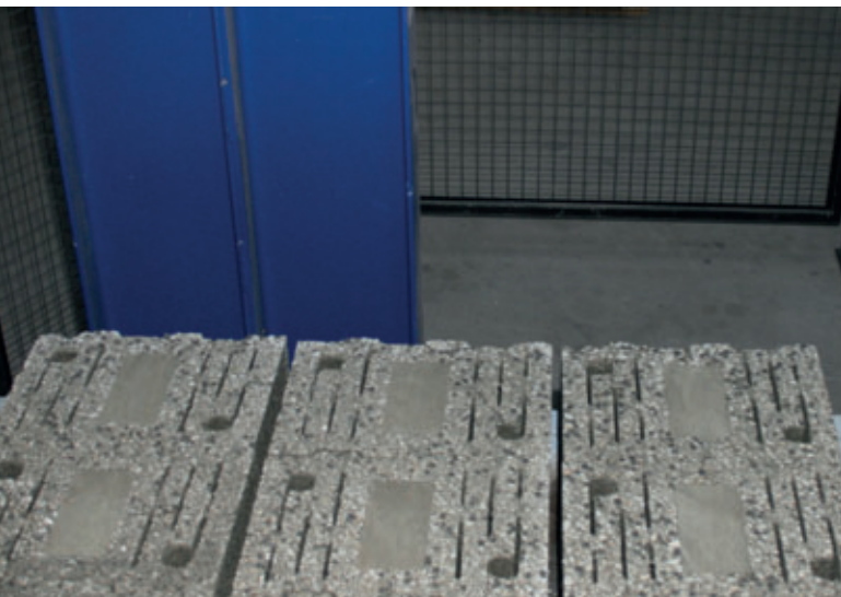
Prima dell'impacchettamento gli strati di blocchi vengono leggermente separati, in modo da consentire in seguito una migliore aerazione dei pacchetti di blocchi.
