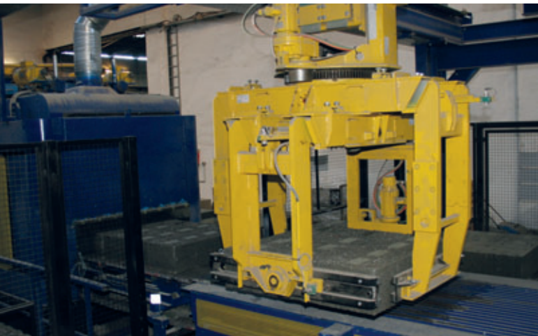
Le préhenseur prend les blocs disposés par couches posés sur les tôles d'acier et les dépose devant l'installation de meulage.
