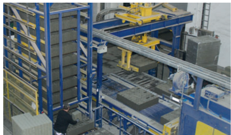
Un collaborateur insère un matériau isolant exactement prédécoupé aux dimensions requises dans les chambres creuses des blocs Jasto Plan Therm.
