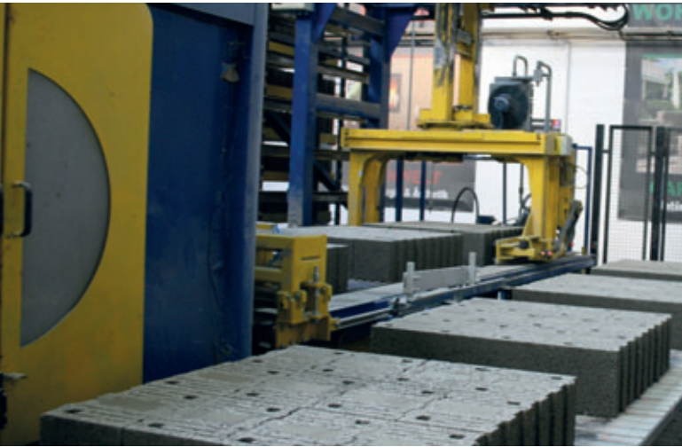
Après le fraisage, les blocs sont posés sur le convoyeur à tabliers en vue de leur transport vers la ligne d'emballage.
