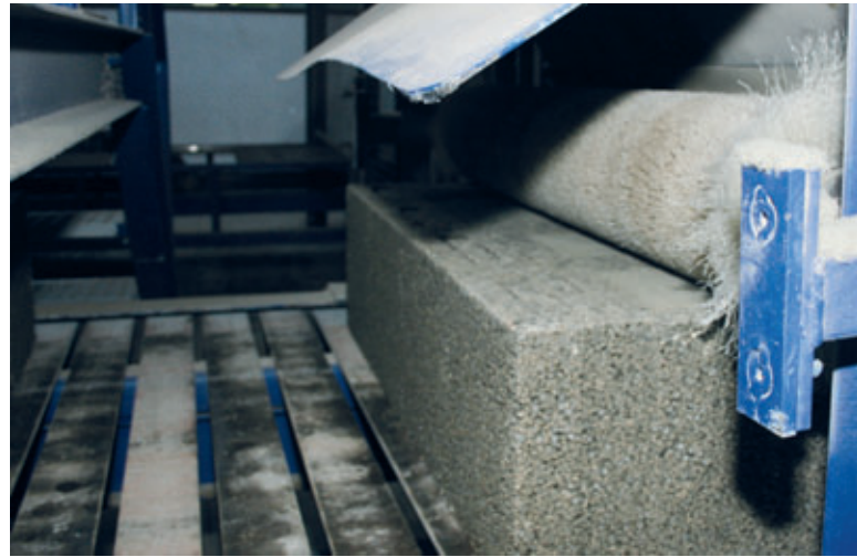
Dernier brossage de la surface pour éliminer les éventuels résidus de fraisage.
