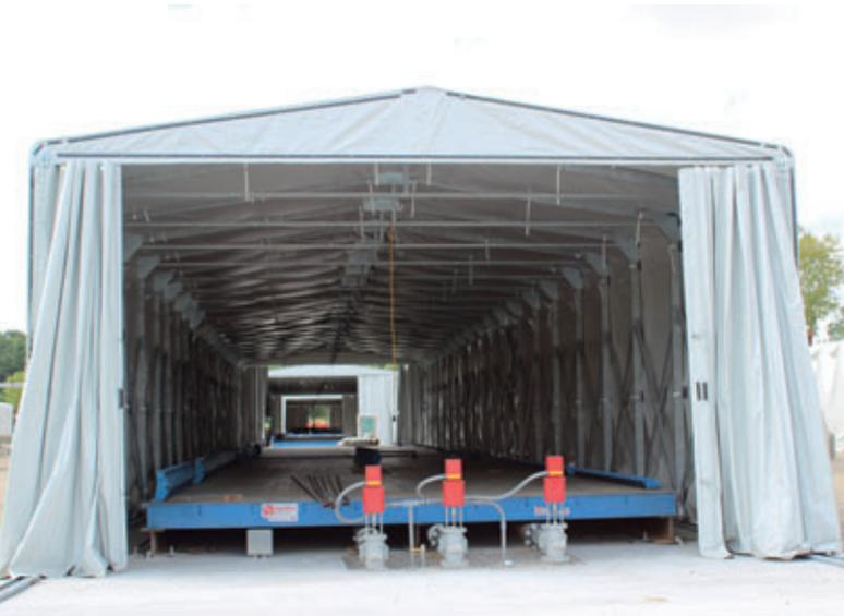
Ventilsteuerung für die Verteilung des Vapors an die
