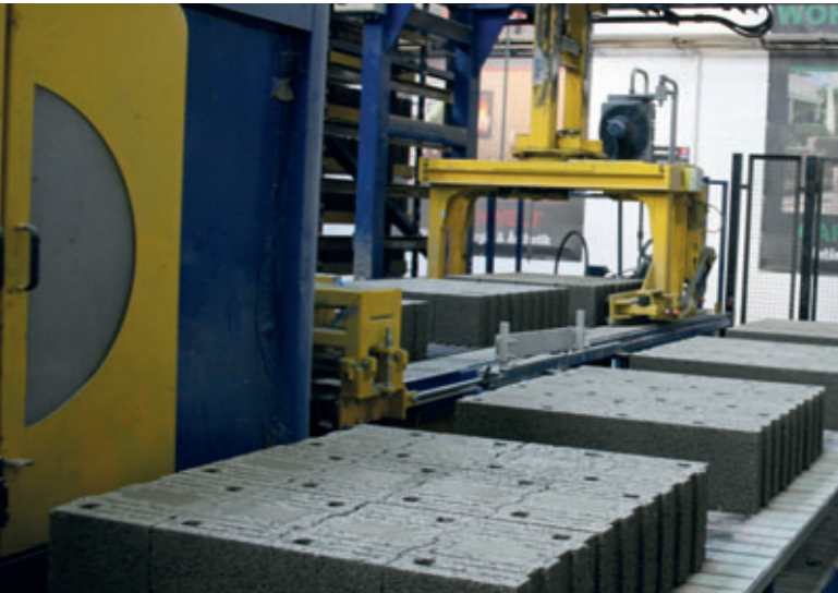
Nach dem Fräsen werden die Steine auf das Plattenförderband gelegt, das diese zur Paketierung befördert.
