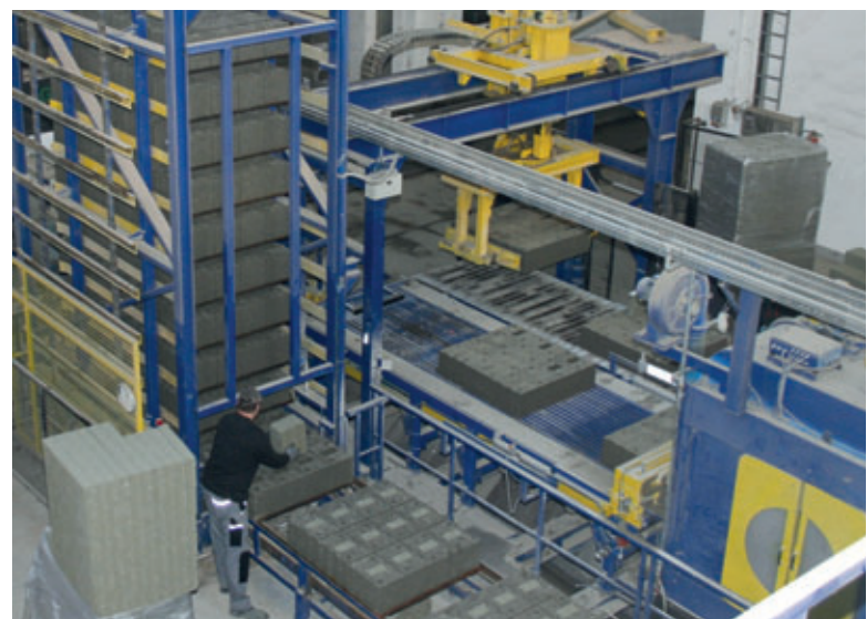
Ein Mitarbeiter steckt passend vorgeschnittenen Dämmstoff in die Hohlkörper der Jasto Plan Therm Steine.
