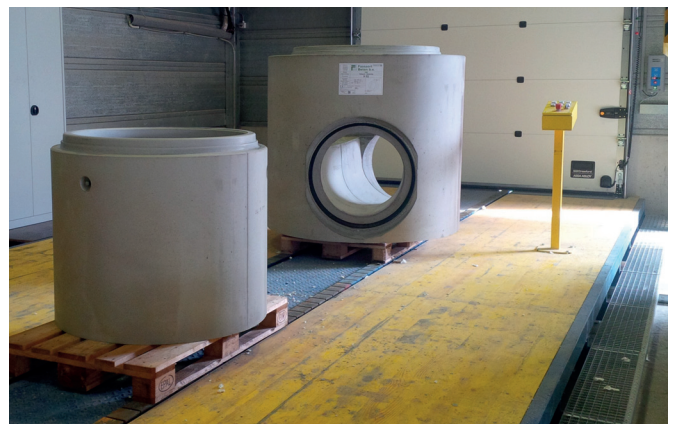
Первые элементы с интегрированными уплотнителями безупречного качества сходят с производственной линии
