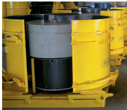
Монтажная высота изделий легко регулируется механизмом опалубки
