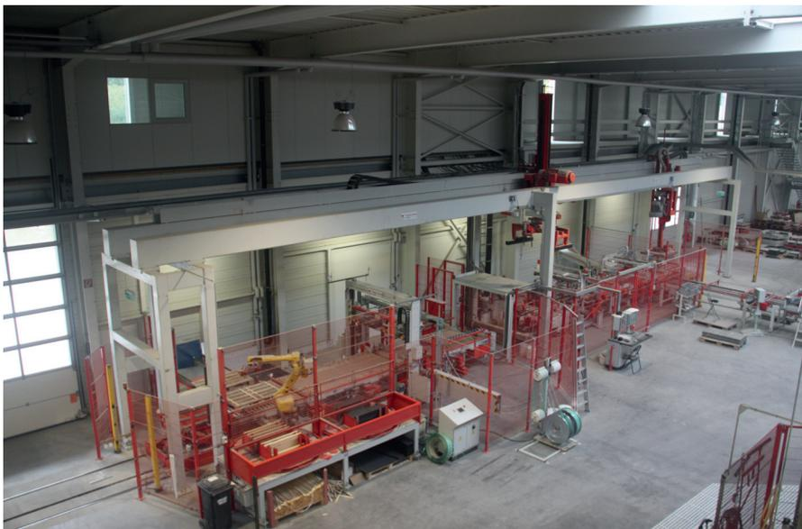
Горизонтальное пакетирование при помощи робота для укладки деревянных реек
