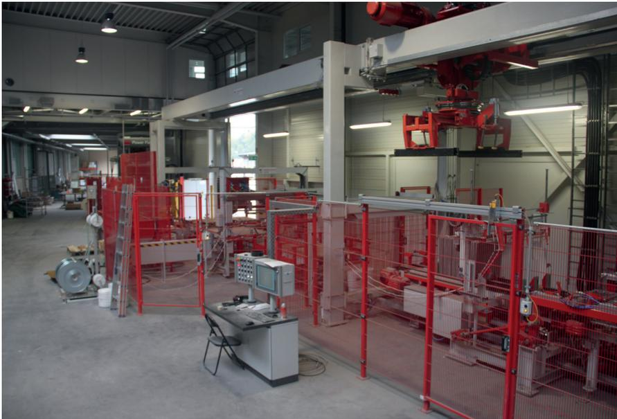
Пакетирование плит при помощи двухсторонних клещей
