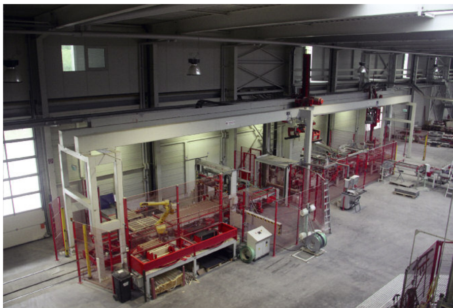
System poziomego i pionowego pakowania płyt z robotem do wkładania drewnianych przekładek.
