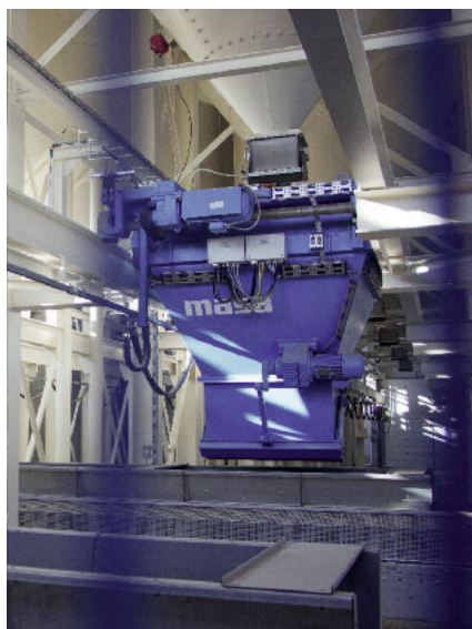
Dwa zasobniki wyposażone w wagę są zasilane z 20 zasobników z kruszywem.
