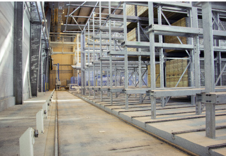
W zależności od zapotrzebowania podkłady produkcyjne są albo buforowane albo udostępniane dla kolejnego cyklu produkcyjnego.
