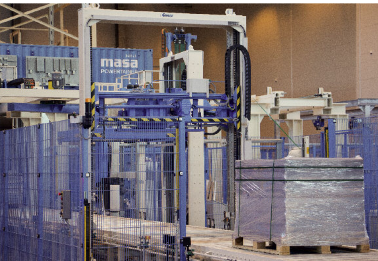
Dobrze zapakowane i gotowe do transportu – kostka brukowa jest pakowana w folię oraz owijana taśmą w pionie i poziomie.
