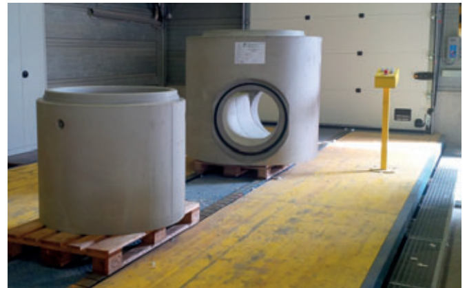
I primi prodotti con le guarnizioni integrate, perfetti dal punto di vista della qualità, escono dall'impianto di produzione per pozzetti.
