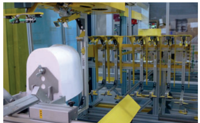
Les négatifs des éléments nécessaires à la constitution de l'empreinte de cunette sont découpés avec précision par les fils chauffants, à partir de matrices pré-moulées en EPS (polystyrène).
