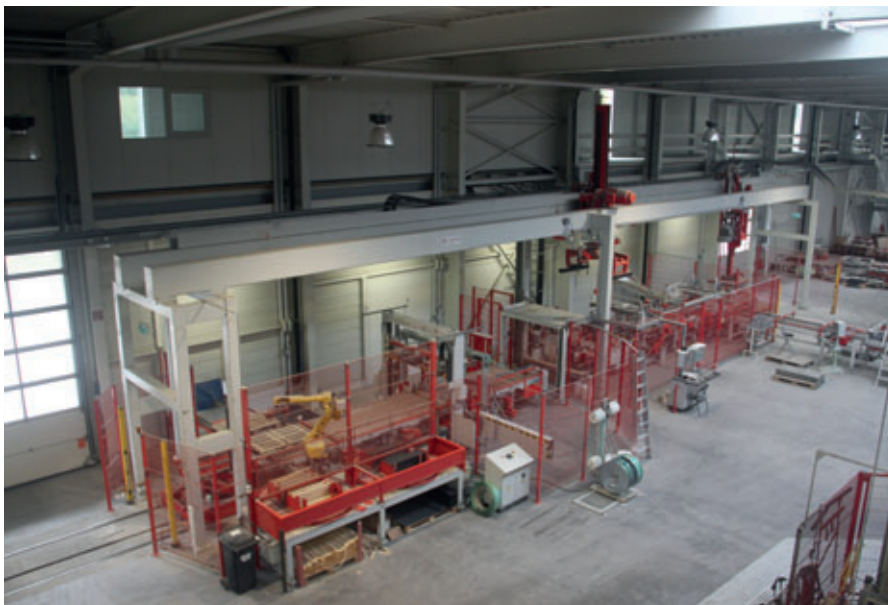
Emballage à plat / sur chant avec robot pour la dépose de lattes en bois
