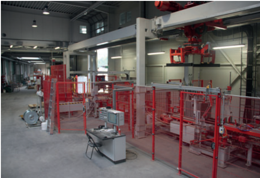
Emballage avec pince 2 côtés pour les paquets de pavés
