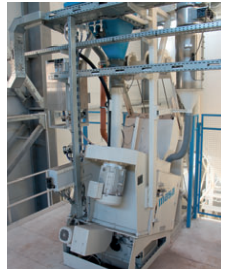
Le mélange pour le béton de parement est réalisé par le malaxeur Masa S 350/500
