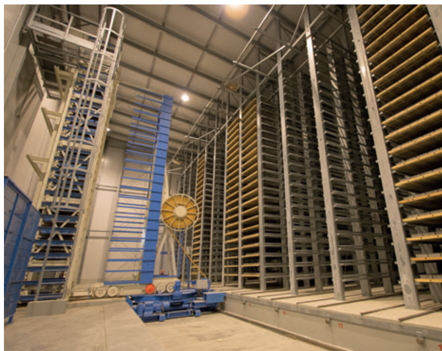
Chambre de séchage avec rayonnages Rotho dans la nouvelle usine russe de la société Vibor-S : capacité globale de 8000 planches
