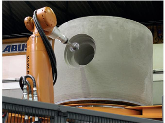
La fresa de hormigón Primuss fresa pasos y canaletas de bases de pozos con una precisión milimétrica
