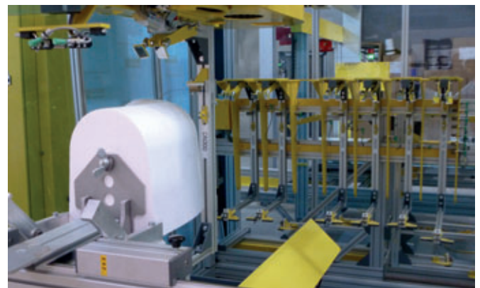
Con la ayuda de sierras de alambre caliente se recortan los negativos para los componentes de canal con medidas exactas a partir de piezas preformadas de EPS.
