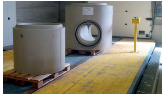
Los primeros productos con juntas integradas abandonan la producción de pozos, con una calidad impecable.
