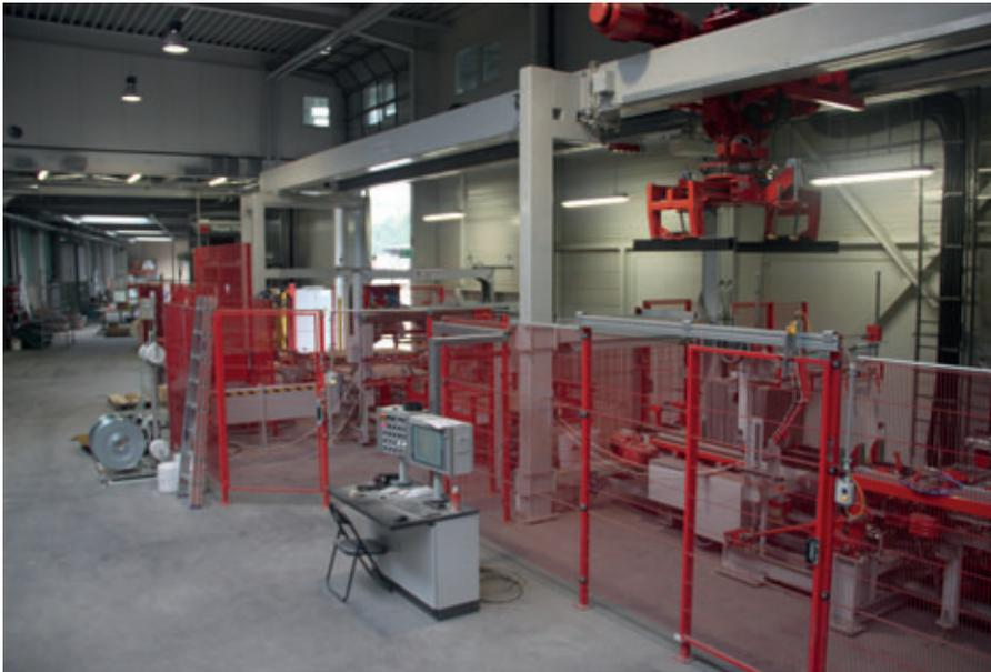
*Sistema de empaquetado con pinza de 2 lados para paquetes de losas*
