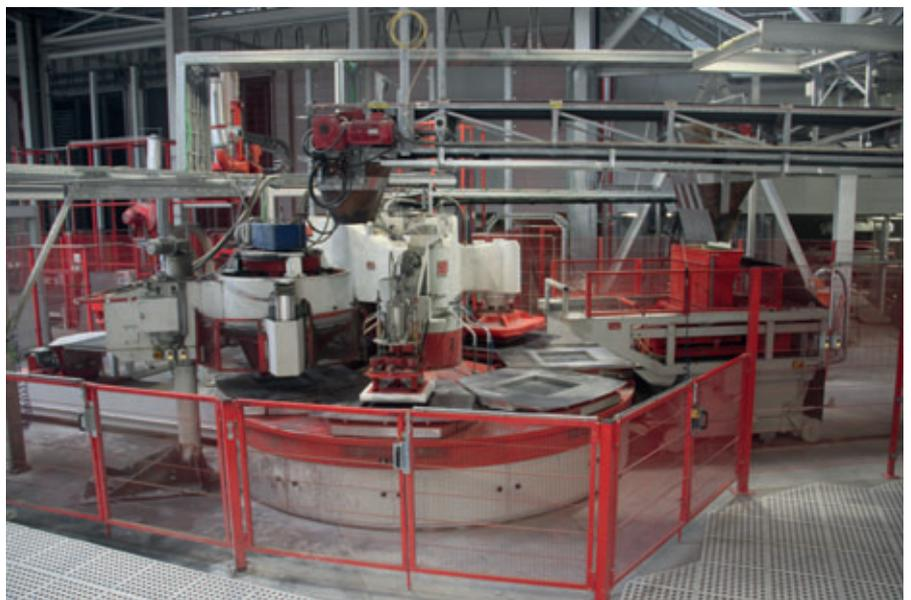
La prensa hermética puede fabricar formatos de hasta máx. 800 x 1000 mm.
