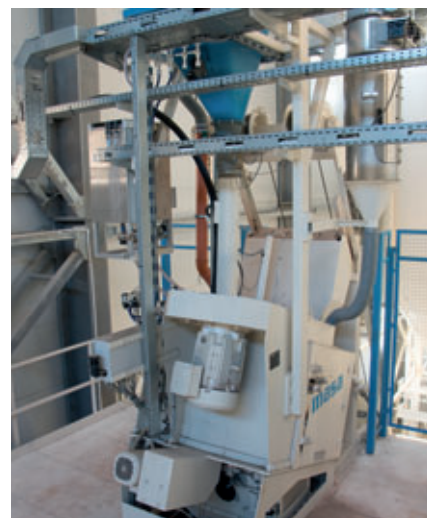
La mezcla de hormigón para el hormigón bicapa se fabrica con la mezcladora Masa S 350/500
