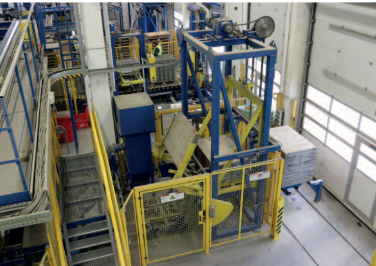
Штабели опалубочных профилей в накопителе
