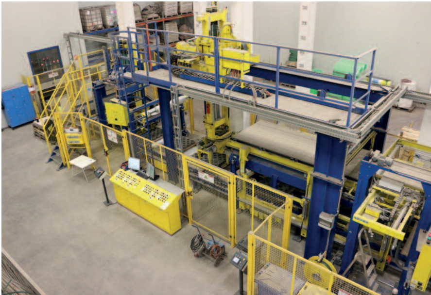
Сухая сторона производства с перегруппировкой блоков мощення; производство садово-ландшафтных изделий и бордюров на оптимальных скоростях
