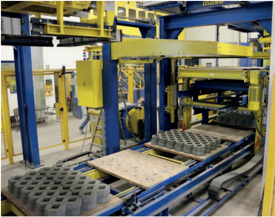
Горизонтальная обвязка отдельных слоев – обвязка производится при обратной транспортировке и перегруппировке
