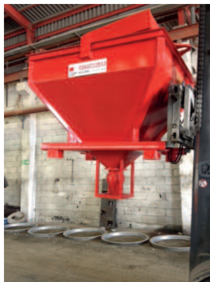
Специальный дозатор сводит к минимуму расслоение бетонной смеси при опорожнении, способствуя сохранению однородности смеси
