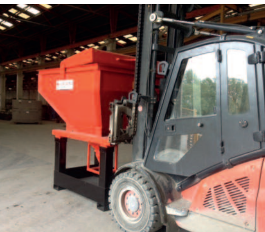
Транспортно-дозировочная бадья CB1800 комбинируется как с краном, так и с погрузчиком
