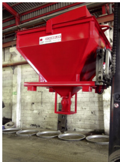
Specjalny mechanizm dozujący zapewnia jednorodność mieszanki betonowej i zapobiega jej segregacji podczas opróżniania zasobnika.
