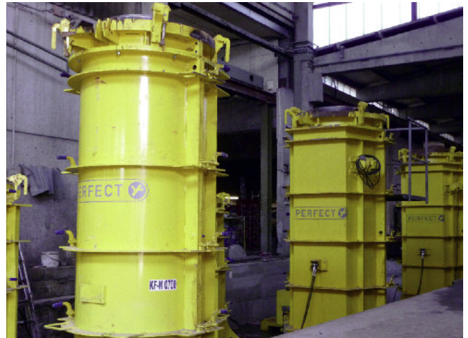
W firmie Beton Müller, w specjalnie przygotowanej hali, ustawione są formy do rur o średnicach od DN 700 do DN 1200.
