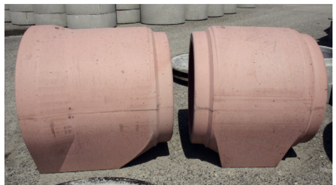
Rury o standardowej długości (3 m), elementy przegubowe i pasowe są odlewane i dojrzewają w formach.
