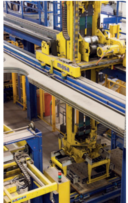
Il Masa Cuboter non punta sui componenti idraulici, ma solo sul servozionamento
