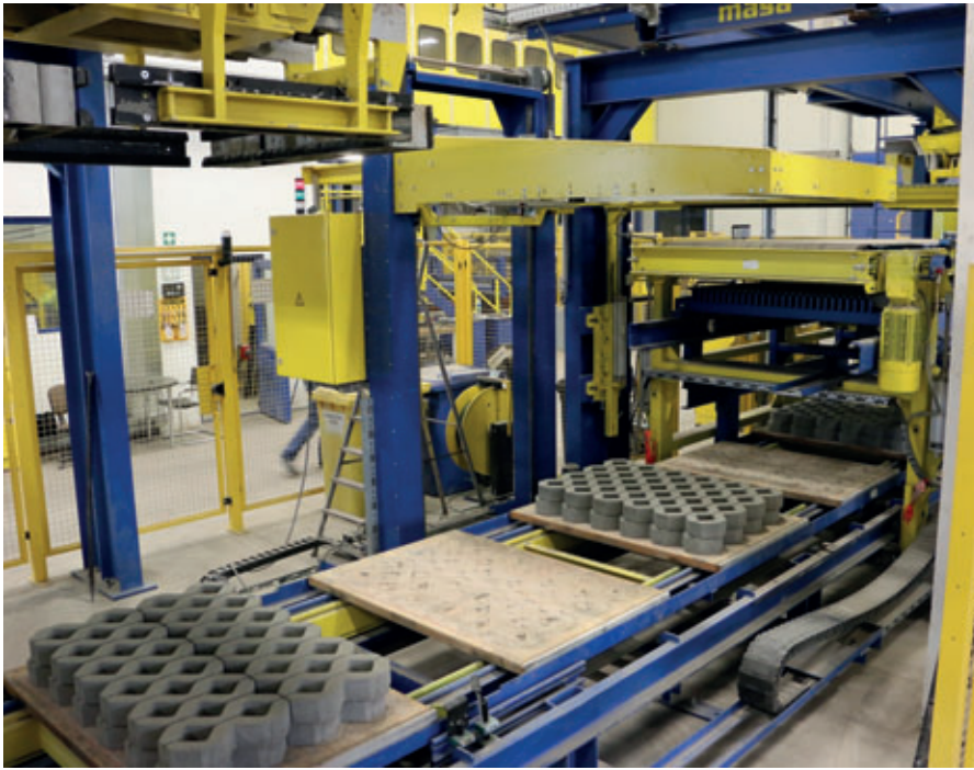
Reggiatura orizzontale per singoli strati – si provvede alla reggiatura sia durante il trasporto del ritorno sia durante il ri-raggruppamento
