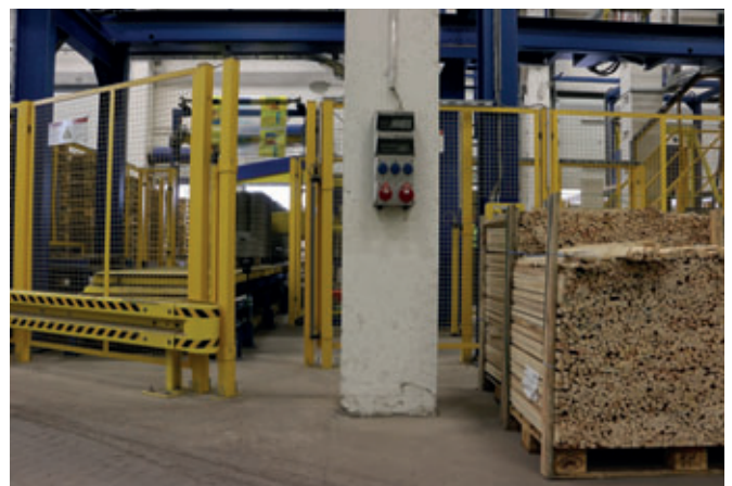
Lavorare in modo sicuro e senza perdita di tempo – le barriere luminose consentono di posizionare i listelli in modo sicuro senza disturbare l'intero processo dell'impianto.
