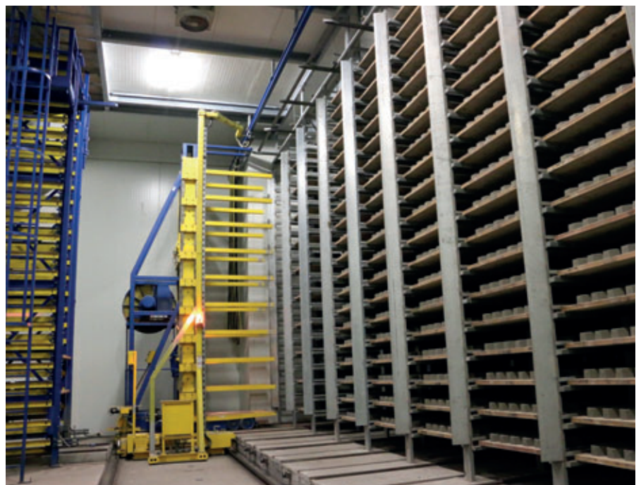
Piattaforma mobile Masa con il nuovo sistema a camera di grandi dimensioni e sistema di ventilazione
