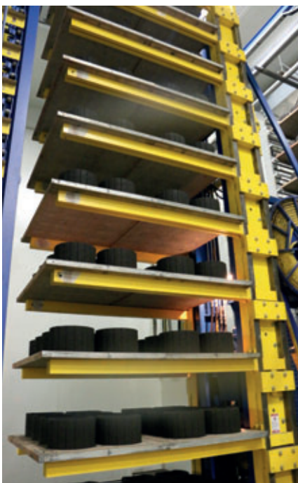
A seconda dell'altezza del prodotto si adatta la distanza tra le forche
