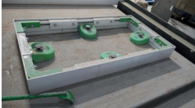
Il sistema FaMe LITE Elematic per casseforme per i fermagetto per finestre e porte su banchi ribaltabili, impianti a carosello e casseforme in serie. Nuovi angolari in alluminio colato assicurano la rettilineità ed ortogonalità dei fermagetto. Un fermagetto per finestre per pannelli di parete dello spessore di  $H = 150$  mm e una taglia pari a  $1 \times 1$  m pesa meno di 30 kg.
