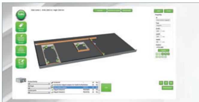
Outil logiciel Elematic FaMe Designer permettant l'élaboration de plans de coffrages.
