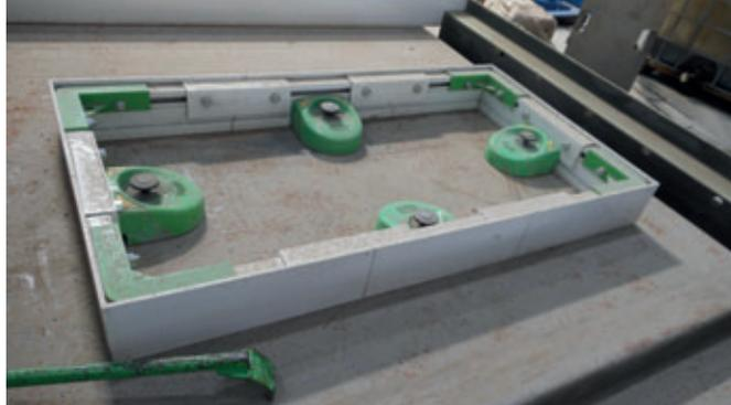
Système Elematic FaMe LITE pour coffrages de portes et de fenêtres sur tables basculantes, circuits de palettes et batteries coffrantes. De nouveaux éléments d'angle en fonte d'aluminium garantissent la rectitude et la perpendicularité des coffrages. Un coffrage de fenêtre pour une épaisseur de panneau mural de  $H = 150$  mm et des dimensions de  $1 \times 1$  m pèse moins de 30 kg.
