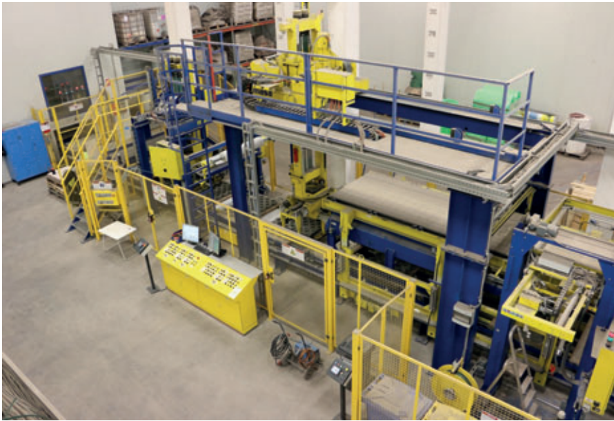
Lado seco con agrupamiento para adoquines; producción de artículos para la construcción de jardines y paisajes y bordillos a una velocidad óptima
