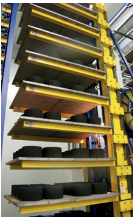
Dependiendo de la altura del producto se adapta la distancia entre las horquillas
