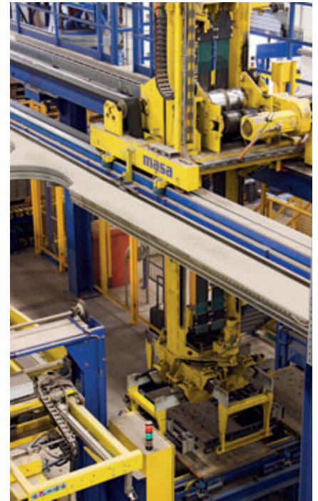
El Masa Cuboter no está formado por componentes hidráulicos, sino exclusivamente por servoaccionamientos
