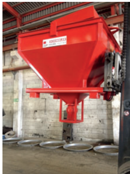
Gracias a la unidad dosificadora especial se evita por completo la segregación del hormigón al descargar y se mantiene la homogeneidad del hormigón.
