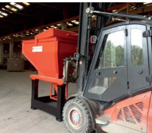
La cuba de transporte y dosificación CB1800 se puede utilizar tanto para el transporte con carretilla elevadora, como con grúa.
