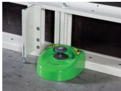
*Nuevo complemento a la familia de productos Elematic FaMe, el molde lateral Flex-Pro para elementos de pared, elementos sándwich y vigas/pilares con una altura de lado de hasta 500 mm. El sistema Flex-Pro solo pesa 7 kg/m.*
