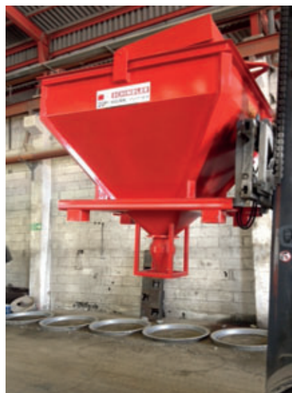
Durch die spezielle Dosiereinheit wird ein Entmischen des Betons beim Entleeren weitestgehend vermieden und die Homogenität des Betons beibehalten.
