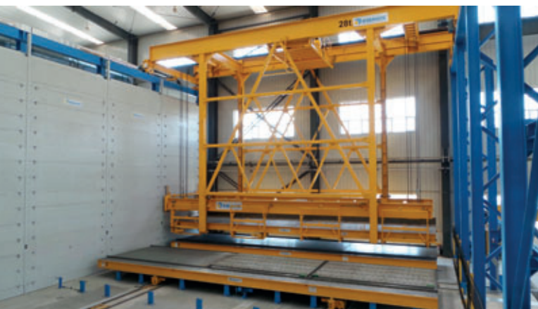
Mit dem Regalbediengerät werden die Paletten automatisch ein- und ausgelagert. Das Stapelregal bietet Platz für maximal 70 Paletten.
