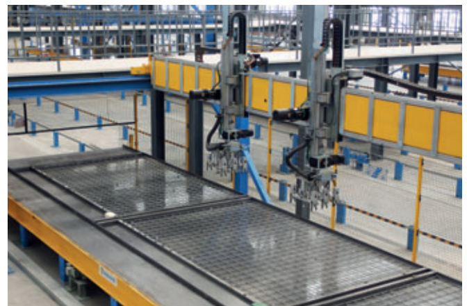
Der Verlegerroboter legt die produzierten Gitterträger vollautomatisch in die Palette ein.
