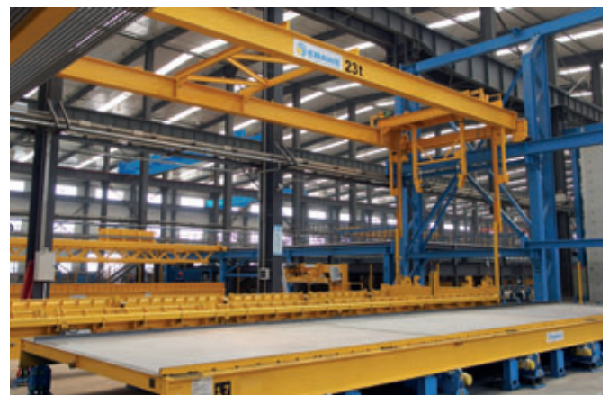
Zur Produktion von Doppelwänden steht eine Wendeeinrichtung zur Verfügung zum Einwenden der Erstschale in die frisch betonerte Zweitschale.
