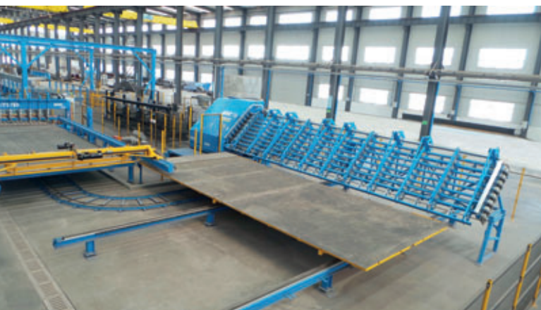
Vollautomatische Mattenschweißanlage M-System Evolution für die Just-in-time-Produktion der Bewehrungsmatten
