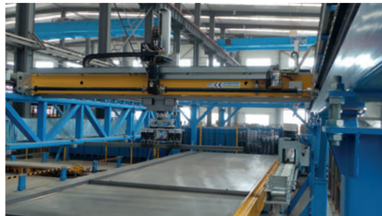
Form Master Schalungsroboter von progress Maschinen & Automation für das präzise Setzen der Schalungen auf die Schallflächen der Paletten
