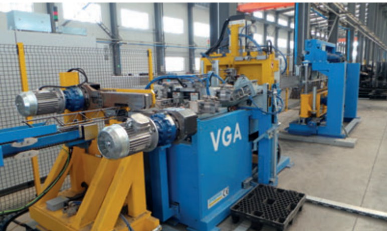
Mit Hilfe der Gitterträger-Schweißanlage VGA 215 werden die Gitterträger in den benötigten Höhen und Längen automatisch produziert und entsprechend zugeschnitten.
