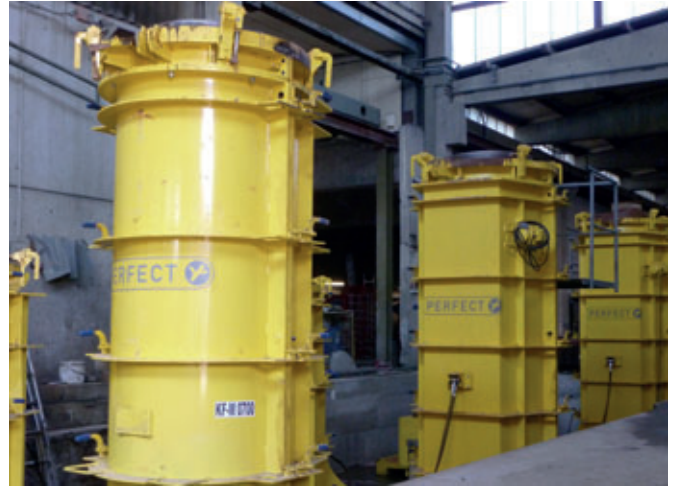
Zur Herstellung der Rohre in den Nennweiten DN700 bis DN1200 wurden bei Beton Müller mehrere Gießformen in einem abgesenkten Hallenbereich in Betrieb genommen.
