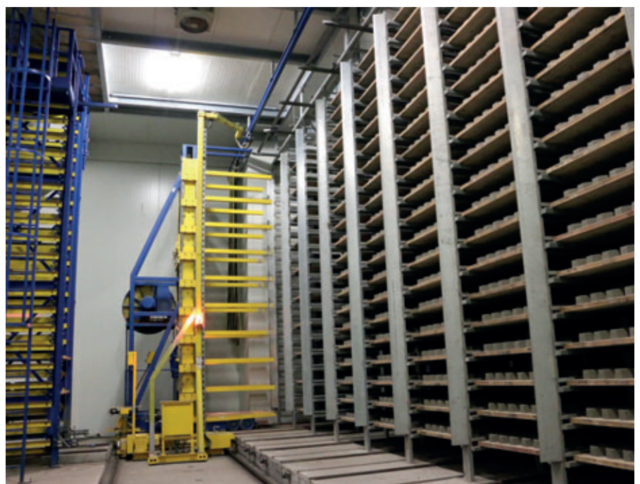
Masa-Schiebebühne mit neuem Großkammersystem und Ventilationssystem
