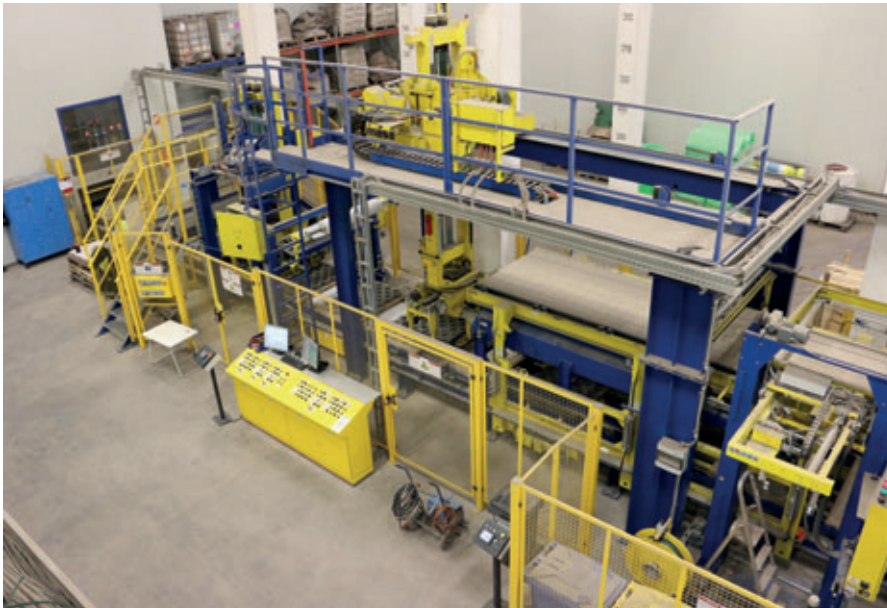
Trockenseite mit Umformung für Pflastersteine; Produktion von Galabau-Produkten und Bordsteinen bei optimalen Geschwindigkeiten
