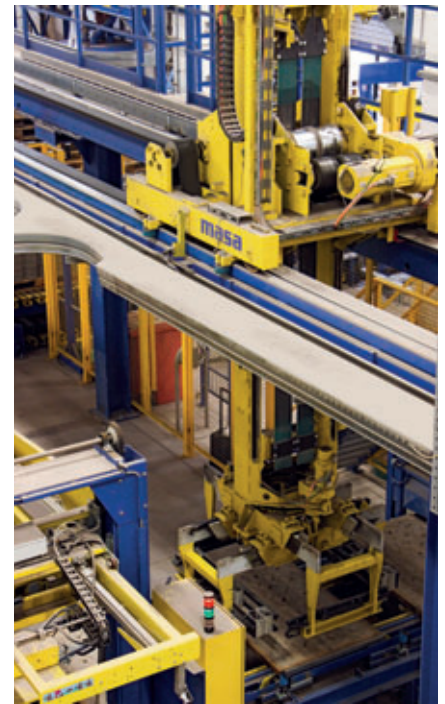
Der Masa Cuboter setzt nicht auf Hydraulikkomponenten, sondern ausschließlich auf Servoantriebe.
