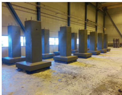
Фундаментные блоки с основанием
