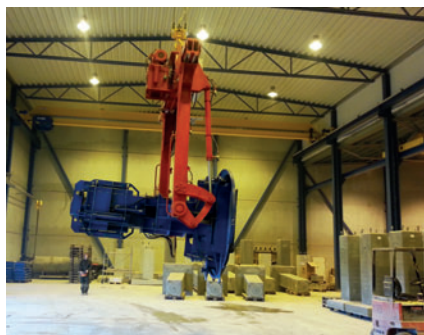
Работа поворотной траверсы
