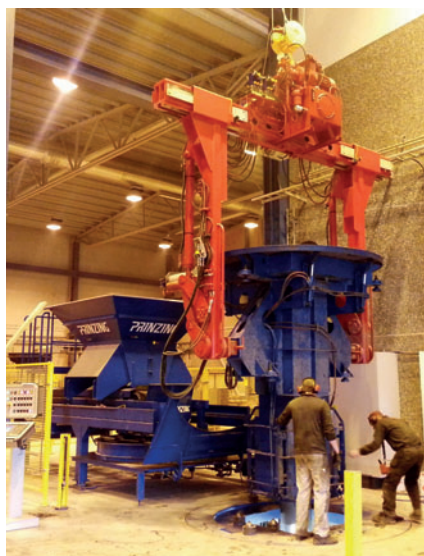
Машина Atlas с поворотной траверсой
