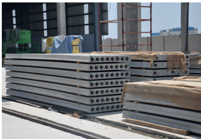
Склад: пустотелые плиты и стеновые панели из сборного железобетона
