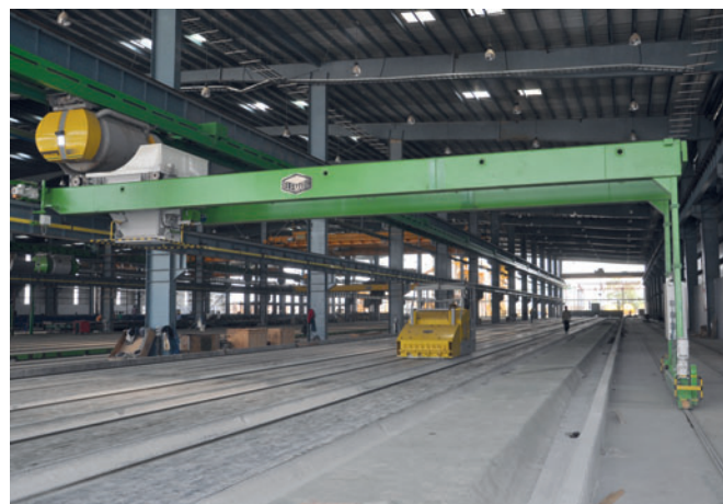
Линия по бетонированию пустотелых плит с использованием системы автоматизированной раздачи бетона
