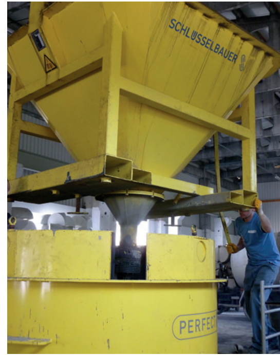
Для производства колец с дном на заводе Werra-Baustoffwerk используется товарный бетон, который заливается в стальные формы при помощи подкрановой бады
