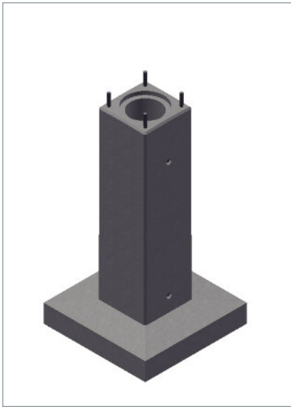
Blok fundamentowy pod słup trakcyjny, ze stopką.
