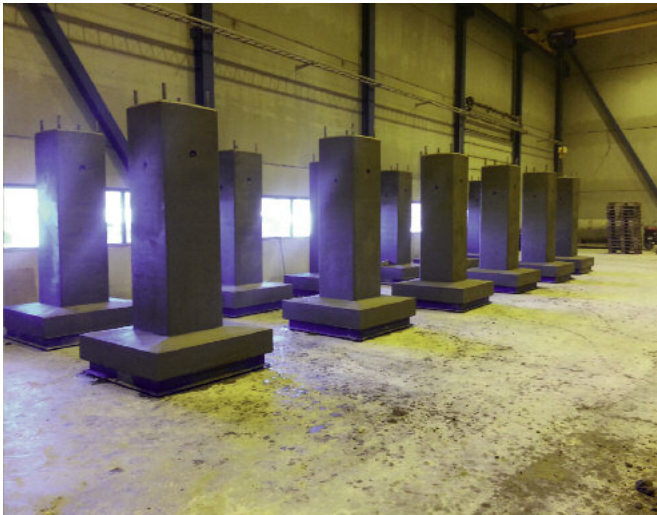
Bloki fundamentowe ze stopką.
